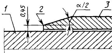
1 — поверхность стебля; 2 — измерительная кромка; 3 — барабан
